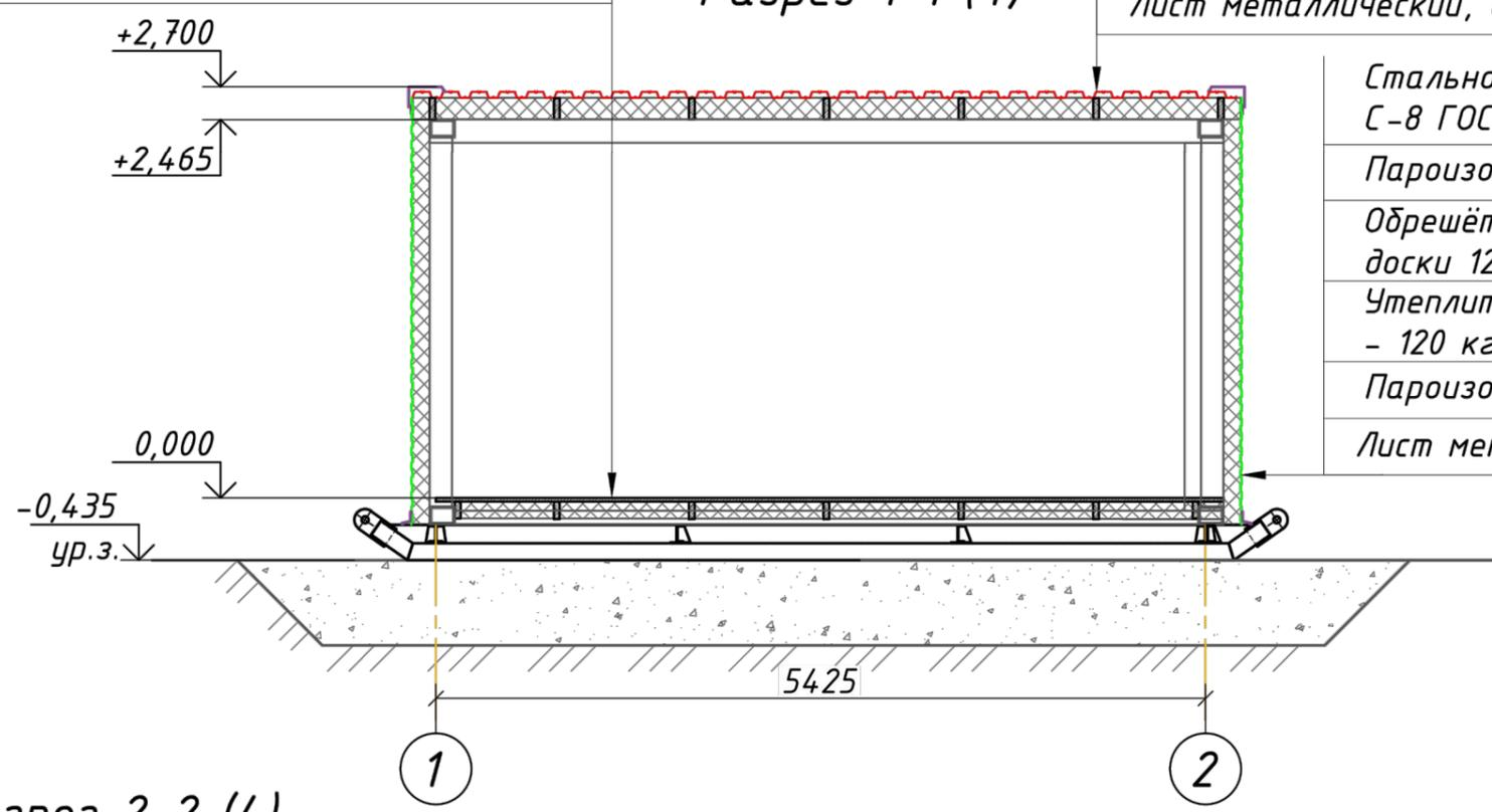
Стальной, оцинкованный профилированный лист С-8 ГОСТ 24045-2016 с полимерным покрытием
